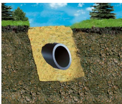
Układanie rur w tradycyjny sposób z obsypką piaszczystą
