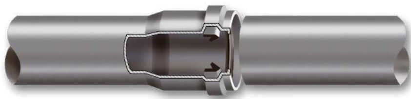
Przekrój przez połączenie rury z kielichem typu Eurosocket, z uszczelką, z bosym końcem.
