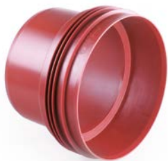
Złączka do połączenia bosego końca rury Pragma®ID z kielichem rury PVC-U lub Pragma OD Adapter to connection Pragma®ID spigot with PVC-U or Pragma OD pipe socket
