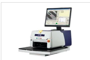
Pomiar grubości warstw
